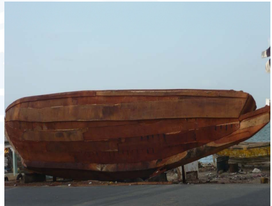
Pirogue artisanale à senne tournantes : 27 m de long, 3 à 3,5 m de largeur, et 3 à 3,5 m de hauteur, Capacité : 3 à 4 camions frigorifiques de 2 à 3 tonnes
